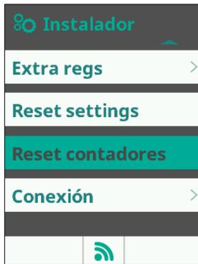
En 'Reset contador' se puede poner a cero el contador de horas de servicio de la célula electrolítica.
