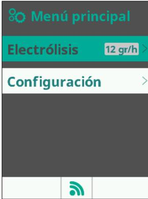
En el menú 'Electrólisis' se realizan todas las configuraciones que afectan a la producción de cloro.
